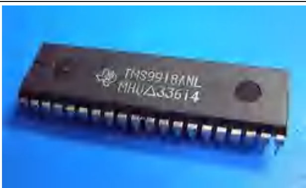
图 18: 1983 年由 TI 推出的第一款 GPU 芯片, 用于雅利达游戏机, 显存仅为 16kb, 分辨率为 256*192
