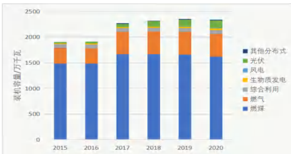
图 2: 苏州市 2015 年至 2020 年发电装机变化
